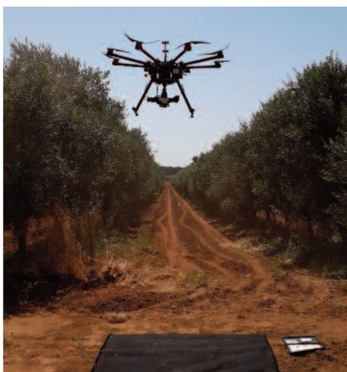
*Fig. 1 - APR equipaggiato con fotocamere RGB e multispettrali ed utilizzato per il rilievi presso un oliveto in prova in provincia di Livorno.*
