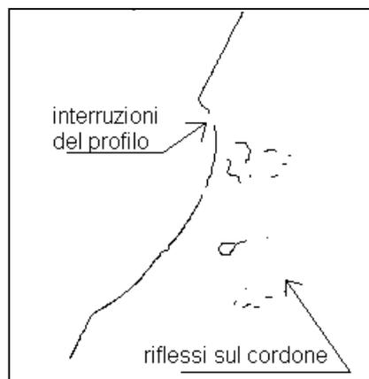
Figura 6.5. Esempio di profilo estratto con irregolarità dovute a problemi di binarizzazione: interruzioni e riflessi del laser sul tratto precedente del giunto (immagine a colori invertiti)
