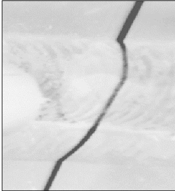
Figura 2.5: Immagine della linea laser proiettata sul giunto saldato, ottenuta con il sensore Qualital (immagine a colori invertiti)
