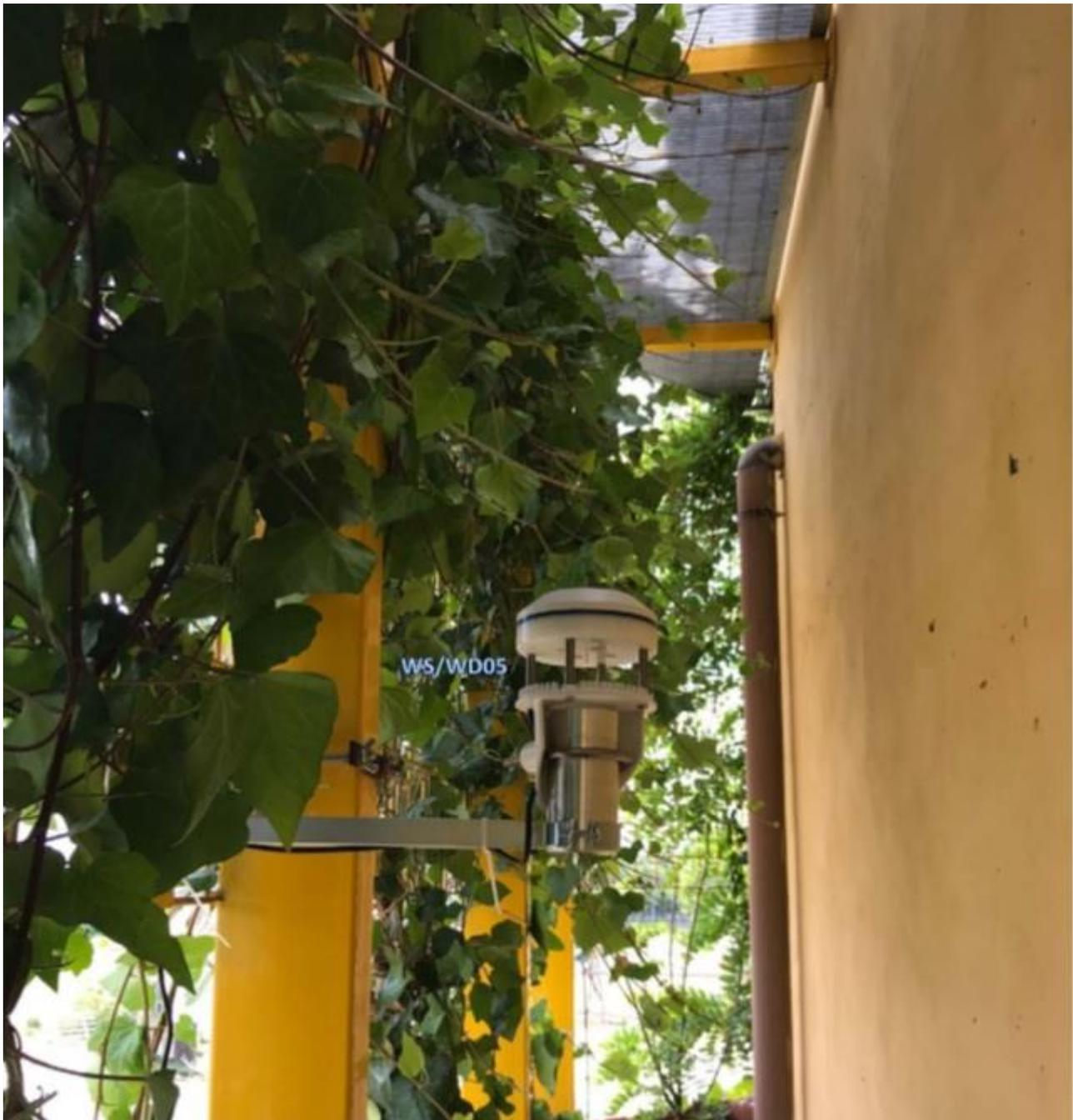
Figura 6 disposizione dei sensori all'interno dell'intercapedine verde della parete Sud-Ovest – piano secondo
