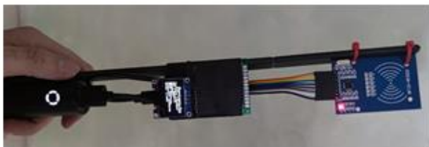
Figura 2: Prototipo della ‘bacchetta magica’ inserita in una intelaiatura di alluminio.
