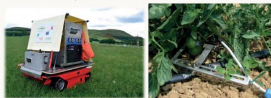
Fig. 2. Strumento per misurare le emissioni GHG dal suolo (sx) e sensore per il monitoraggio dell'accrescimento dei frutti (dx).
